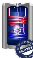
**EHRE-Hochleistungsunterstellspeicher** emailliert, 50mm PUR-Hartschaum-Isolierung direkt geschäumt mit Skymantel, Thermometer, Magnesiumanode 5/4", Skymantel silber, Anschlüsse oben am Speicher, Betriebsdruck 10 bar, Wärmetauscher Betriebsdruck 16 bar. Flansch 180mm (Auch in Weiß verfügbar)
